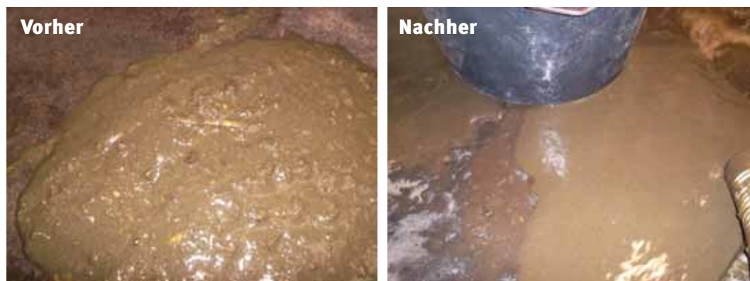
Abb. 22: Gärrest vor und nach dem Durchfluss durch die Desintegrationseinheit Plurry-Maxx
