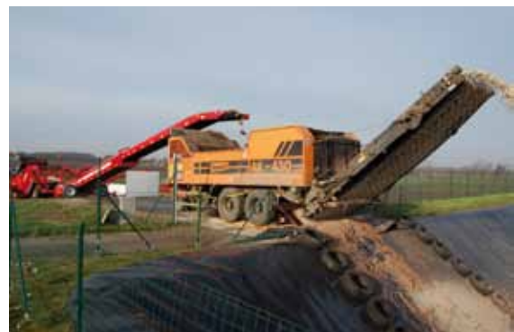
Abb. 14: Transport der Rüben auf dem Beet-Loader (Fa. Grimme) zum Schredder (Fa. Doppstadt) mit direkter Übergabe des Rübenmuses ins Erdbecken
