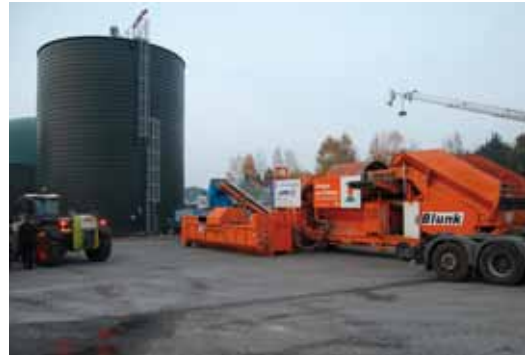
Abb. 10: Blunk-Wäsche mit Steintrennung und Beet-Cruscher (Fa. Putsch) am Standort Messingen mit Hochsilolagerung
