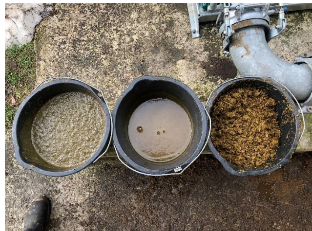
Die verschiedenen Phasen des Gärrestes (Links: Roh; Mitte: Separiert, flüssig; Rechts: Separiert, fest)
