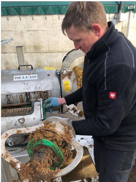
Harald Meyer beim Siebwechsel des Separators
