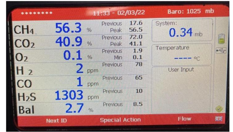
Beispiel Gasmessung Pilot Fermenter Dankers
